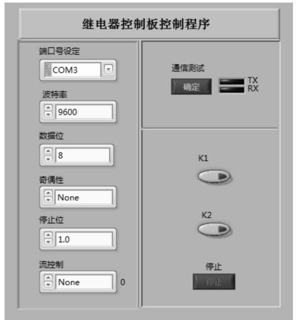
图 5 继电器控制板控制程序前面板
