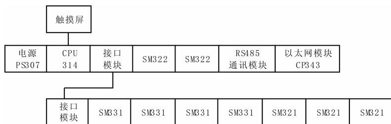
图 2 S7 — 300 系列 PLC 的硬件结构
