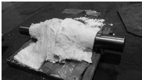
图1 渗碳齿轮轴敷干冰深冷处理
